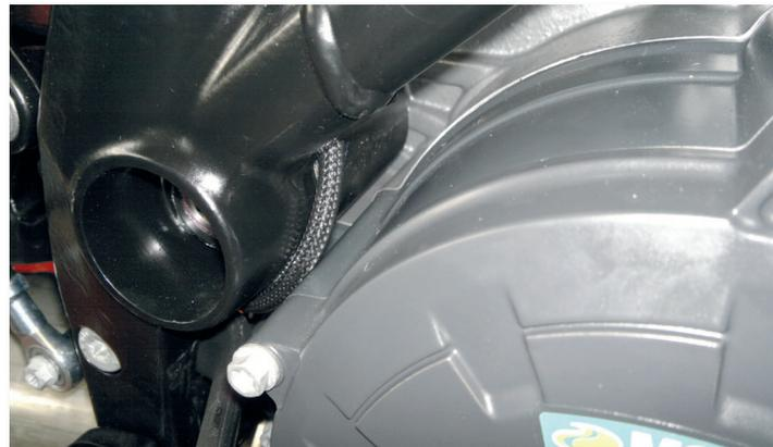
**Image 36** Conduite d'huile au niveau de l'axe du bras oscillant recouverte avec une gaine tressée noire pour être camouflée
