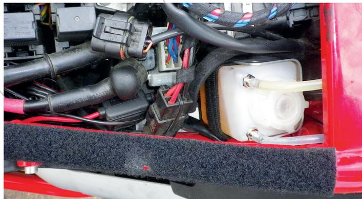
Image 4 Réservoir d'huile intégré dans le support alu
