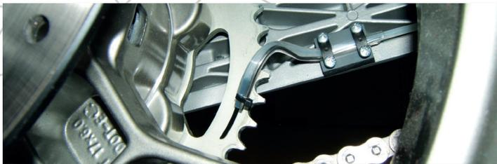
**Image 24** Montage du bloc de maintien sur un bras oscillant à deux bras, buse sur face interne
