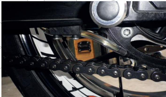
Image 29 Support sous le bras oscillant. Buse sur l'extérieur de la couronne.
