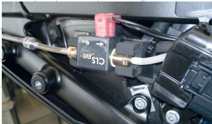
**Image 7** Support en caoutchouc de la pompe collé à la plaque de maintien, plaque de maintien fixée à la moto avec des colliers de serrage.
