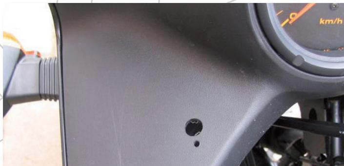
Image 10 Trou de 10 mm pour l'axe de commutateur rotatif et trou de 3,5 mm pour l'ergot anti-rotation dans le revêtement de cockpit
