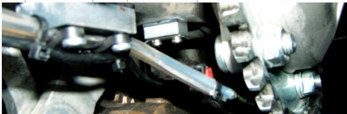
**Image 23** Montage du bloc de maintien sur un bras oscillant de type monobras
