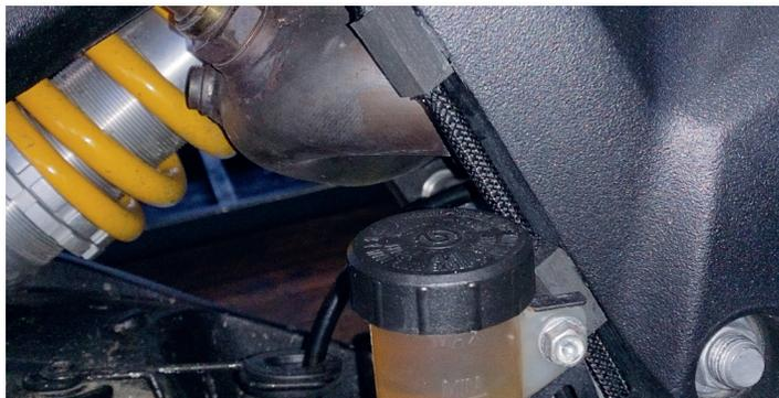
**Image 37** Conduite d'huile sur une Ducati Monster 1100 EVO, recouverte d'une gaine tressée entre les gaines de maintien.
