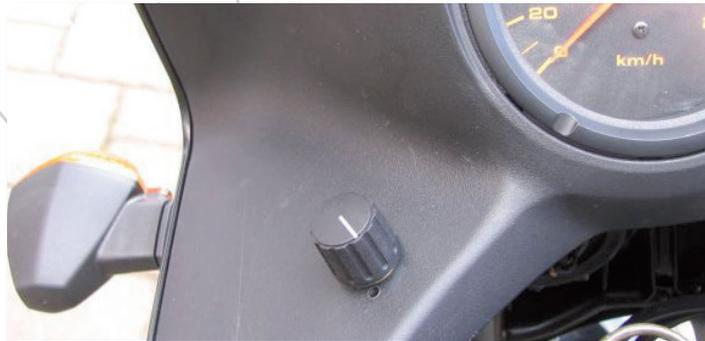
Image 11 Commutateur rotatif intégré avec bouton rotatif et couvercle
