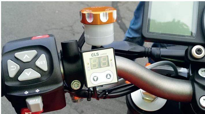
Image 47 Affichage en mode graisseur de chaîne.
