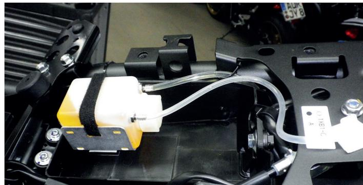
**Image 6** Tuyau de mise à l'air fixé au-dessus du niveau d'huile avec un clip de fixation et un raccord
