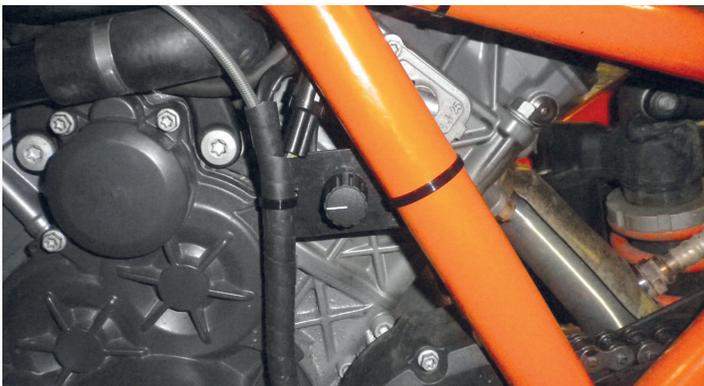
**Image 12** Commutateur rotatif installé sur le côté de la moto
