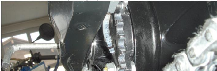
**Image 25** Montage du bloc de maintien sur la face interne du bras oscillant
