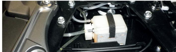
**Image 5** Réservoir d'huile dans le support de réservoir en alu (fourni)
