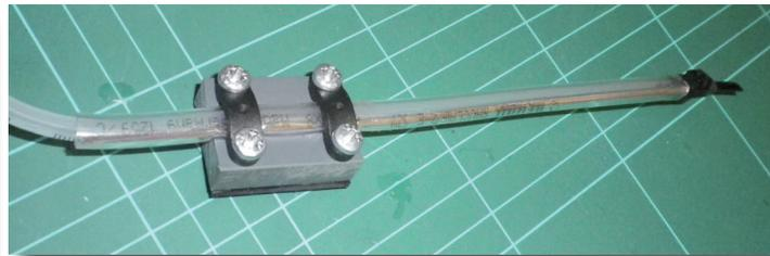
**Image 22** Pour montage sur un bras oscillant de type monobras ou pour montage du bloc de maintien sur la face interne du bras oscillant
