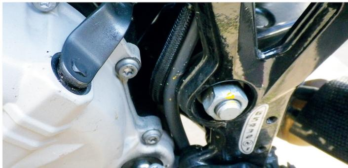
**Image 38** Conduite d'huile sur la Husqvarna Nuda 900 au niveau de l'axe du bras oscillant dans le champ de vision, donc recouverte d'une gaine tressée.
