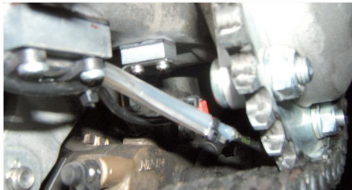
**Image 33** Conduite d'huile sur une Honda VFR 800. En arrière-plan le capteur de vitesse du CLS EVO Sport.
