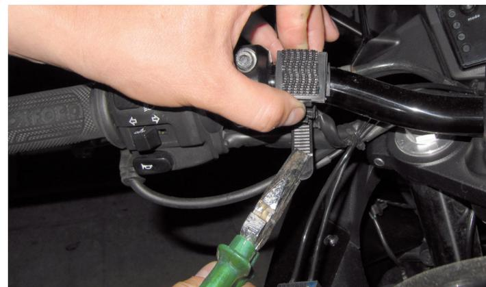
**Image 13** Ajout du support du CLS Control Display au guidon
