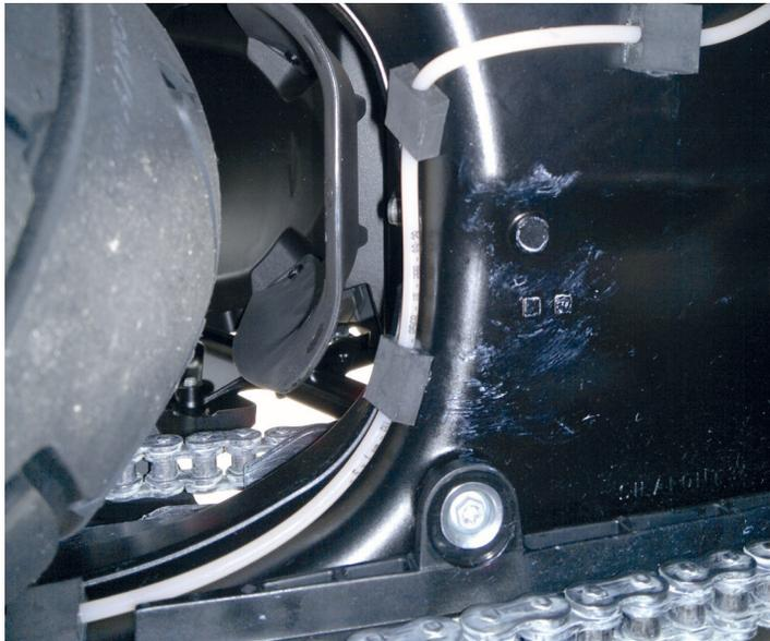
**Image 27** Pose de la conduite d'huile sur la face interne et inférieure du bras oscillant
