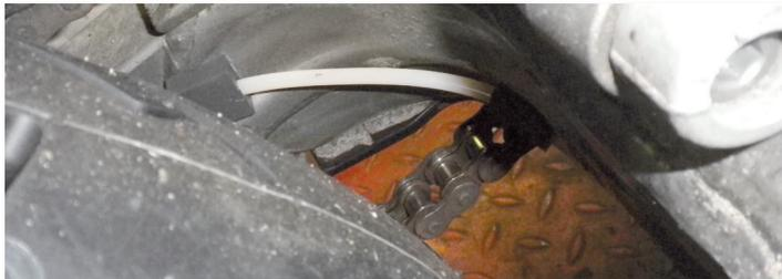
**Image 35** Conduite d'huile posée sur la face interne du bras oscillant
