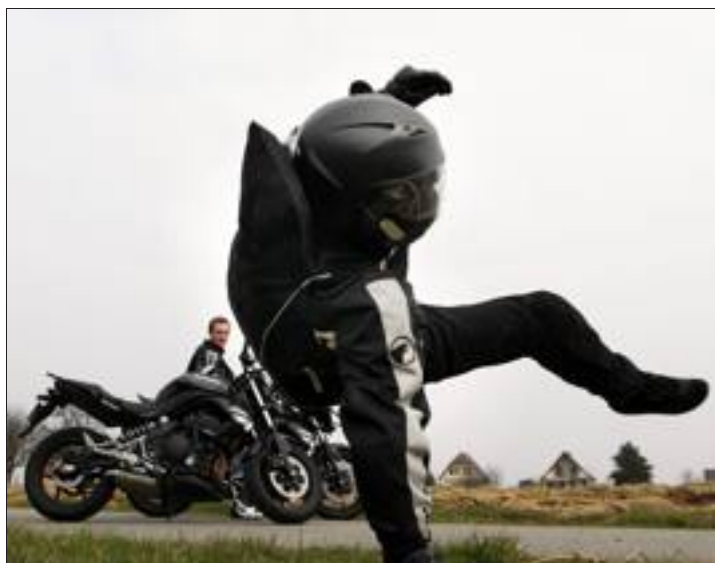
Quand la moto chute, un câble qui relie le gilet airbag à la selle de la moto percute une cartouche de gaz qui, en 80 millisecondes, gonfle une protection dorsale qui va du casque au bas des reins.
